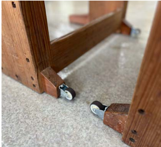
資料_fig9_取り付けしたキャスターの様子
